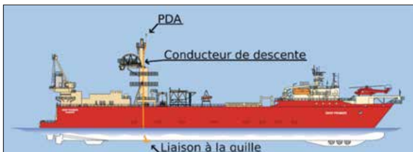
Figure 9 : Protection anti-foudre d'un navire câblé.
